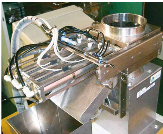
付着鉄粉の除去作業を自動化した自動清掃タイプ
