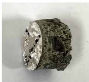
内壁吹付塗材
