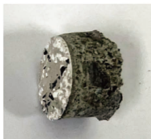
内壁吹付塗装
